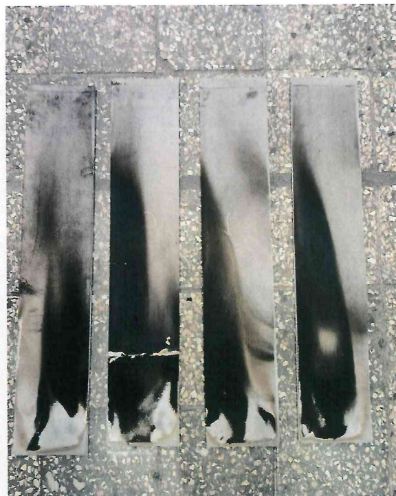
Рис.2. Общий вид образцов после проведения испытаний по определению группы горючести
